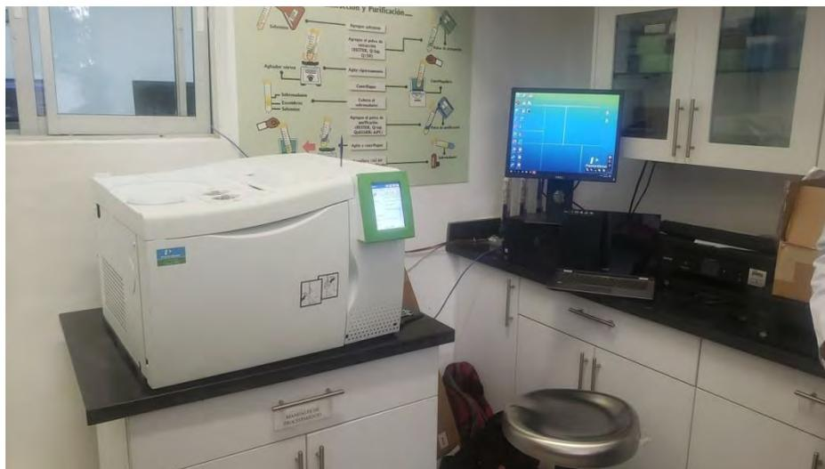
*Figura 3: Cromatógrafo de gases Perking-Elmer completo (con computadora, impresora y software).*
