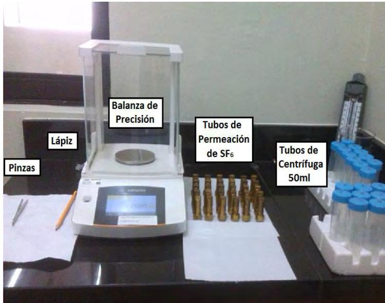
Figura 1: Entorno de Pesaje de los Tubos de Permeación de SF<sub>6</sub>
