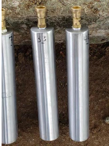
*Figura 9: Cilindros de metal diseñados por el equipo tecnico para coleccionar metano enterico y fabricados en el pais*
