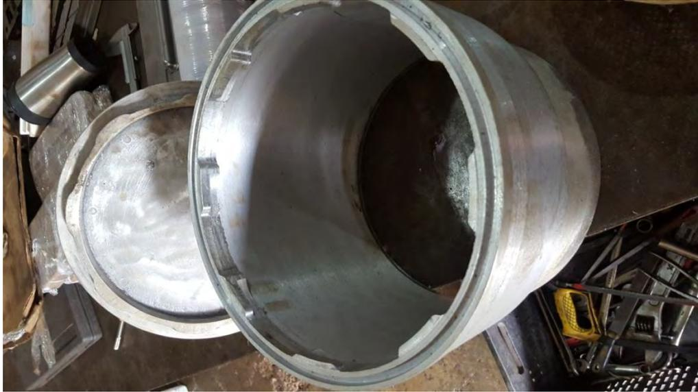
*Figura 5: Cámara estática de aluminio para coleccionar Óxido Nitroso en el suelo fabricadas en el país por diligencias de los técnicos del proyecto*
