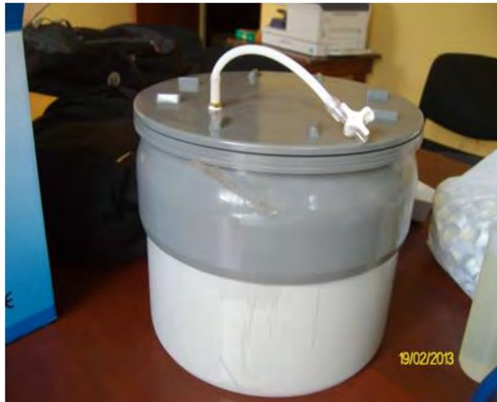
*Figura 6: Cámara estática de colección de óxido nitroso importada de Nueva Zelanda por el equipo técnico del proyecto*
